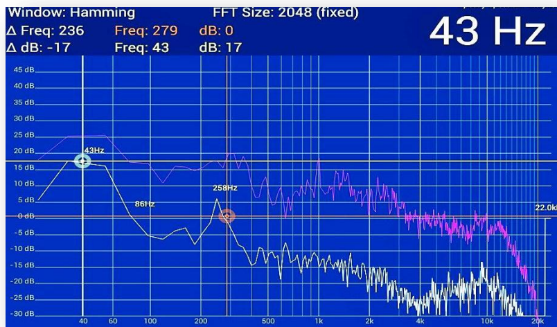
Snimak ekrana spektralnog analizatora s frekvencijom sempliranja 48kHz i Hamming prozorom pri mjerenju spektra buke u prostoriji
