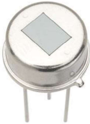
Slika 2: PIR senzor s tremi nogicami
