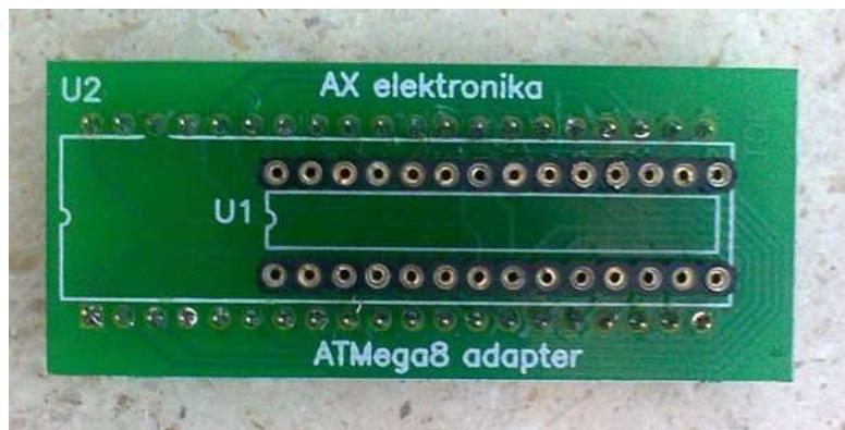
Slika 11: Adapter za ATmega8 mikrokontroler
